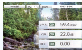
映像・音声確認機能画面(全画面)+測定値(スカパー！プレミアムサービスを除く)
